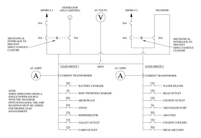
NOTE: AMPERAGE RATINGS FOR THE BREAKERS SHOWN ABOVE ARE 1/2 THE VALUE FOR INTERNATIONAL BOATS EQUIPPED WITH A 220V-50 HZ SHORE POWER SYSTEM.
