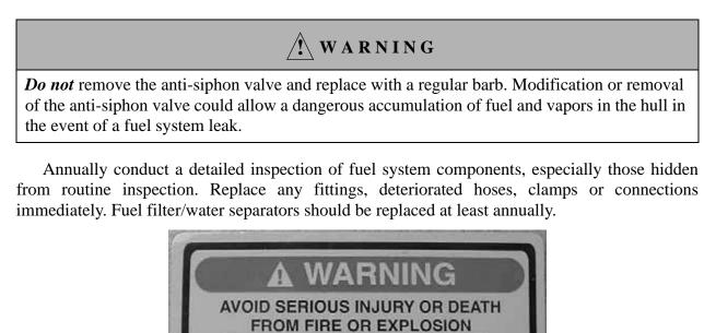
RESULTING FROM LEAKING FUEL. INSPECT SYSTEM FOR LEAKS AT LEAST ONCE A YEAR.
